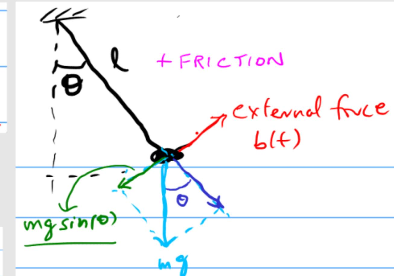
$$\frac{d\vec{x}}{dt} = \begin{bmatrix} 0 & 1 \\ -\frac{g}{l} & -\frac{k}{m} \end{bmatrix} \vec{x} + \begin{bmatrix} 0 \\ +\frac{u(t)}{m} \end{bmatrix}$$
